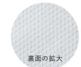
ドライシルキータッチの裏面は、凹凸構造になっており、肌への接触面積を少なくし、肌離れ性を高めています。
